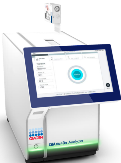
Figura 28. Introducerea QIAstat-Dx Respiratory SARS-CoV-2 Panel Cartridge în QIAstat-Dx Analyzer 1.0.
