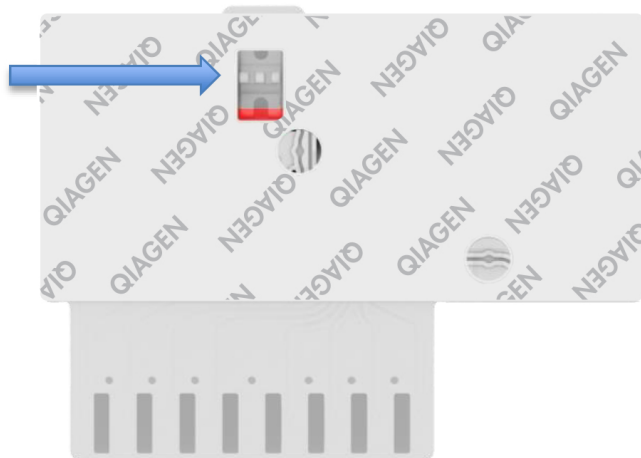
Figura 23. Vizorul de inspecție a probelor (săgeata albastră).
