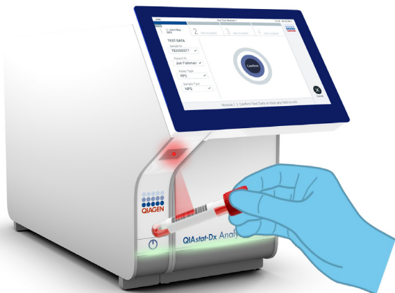
Figura 11. Scanarea codului de bare pentru ID-ul probei.
