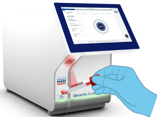
Figura 24. Scanarea codului de bare pentru ID-ul probei.
