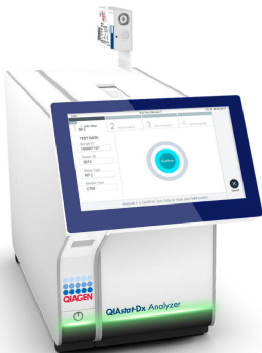
Ryc. 15. Umieszczanie kasety QIAstat-Dx SARS-CoV-2/Flu A/B/RSV Panel Cartridge w analizatorze QIAstat-Dx Analyzer 1.0 lub QIAstat-Dx Analyzer 2.0.
