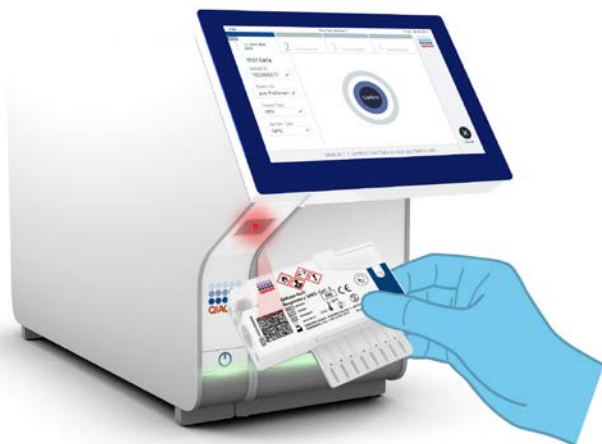
12 pav. „QIAstat-Dx Respiratory SARS-CoV-2 Panel Cartridge“ brūkšninio kodo nuskaitymas.
