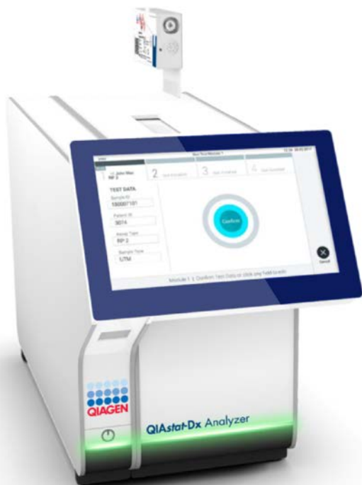
28 pav. „QIAstat-Dx Respiratory SARS-CoV-2 Panel Cartridge“ įdėjimas į „QIAstat-Dx Analyzer 1.0“.
