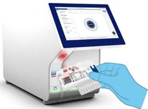
25 pav. „QIAstat-Dx Respiratory SARS-CoV-2 Panel Cartridge“ brūkšninio kodo nuskaitymas.
