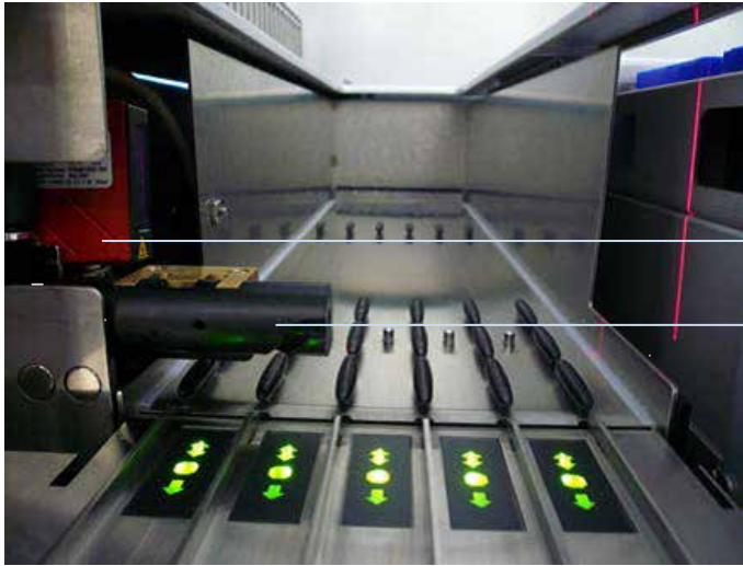
Ubicación del lector de códigos de barras y del separador.
