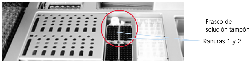
Ranura del frasco de solución tampón.
