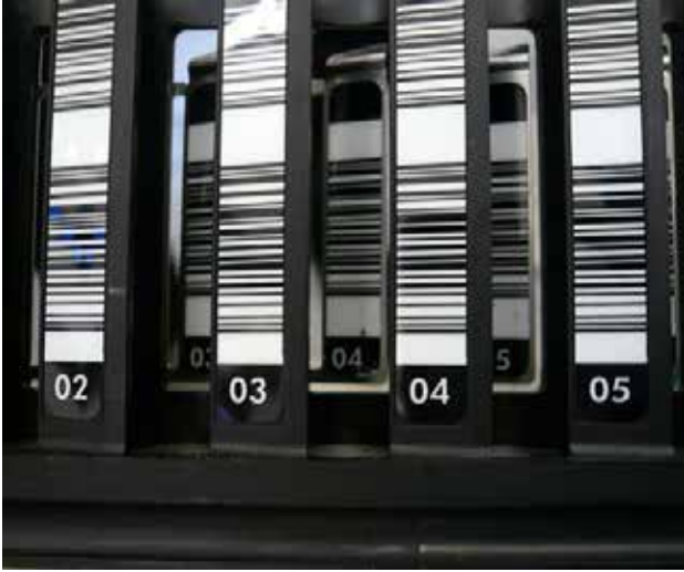
Ejemplo de inserto para soporte de tubos.
