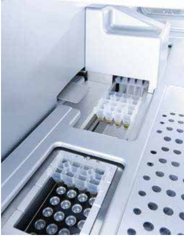
Estación de lisis del instrumento QIASymphony SP.
