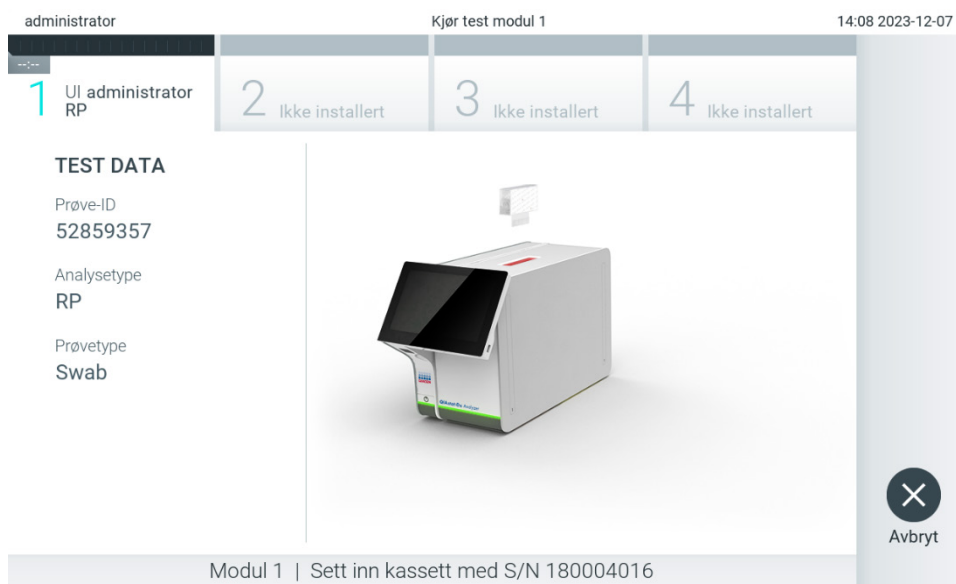
Figur 27. Innsetting av analysekassetter til QIAstat-Dx i QIAstat-Dx Analyzer 2.0
