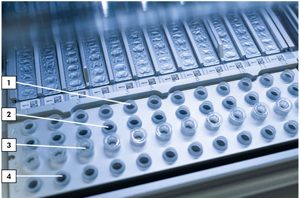
Figur 5. Arbetsbordet av ett EZ2 Connect MDx-instrument. (1) Provrör (ST) (2 ml) laddade i rad A. (2) Tomt eller valfritt: Rör (2 ml) innehållande 80 % etanol för valfritt tvättsteg, laddat i rad B. (3) Engångspets hållare (DTH) som innehåller engångsfilterspetsar (DFT) laddade i rad C. (4) Elueringsrör (ET) (1,5 ml) laddade i rad D.
