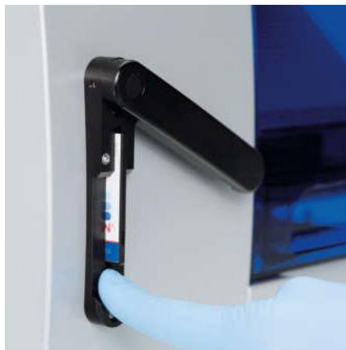
Figur 7. EZ1 Card fullständigt infört i öppningen för EZ1 Card.
