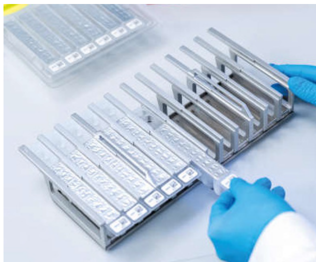
Figura 3. Rack de cartucho de reagentes. O próprio suporte de cartuchos está identificado com uma seta para indicar a direção na qual se devem carregar os cartuchos de reagentes (RCB).
