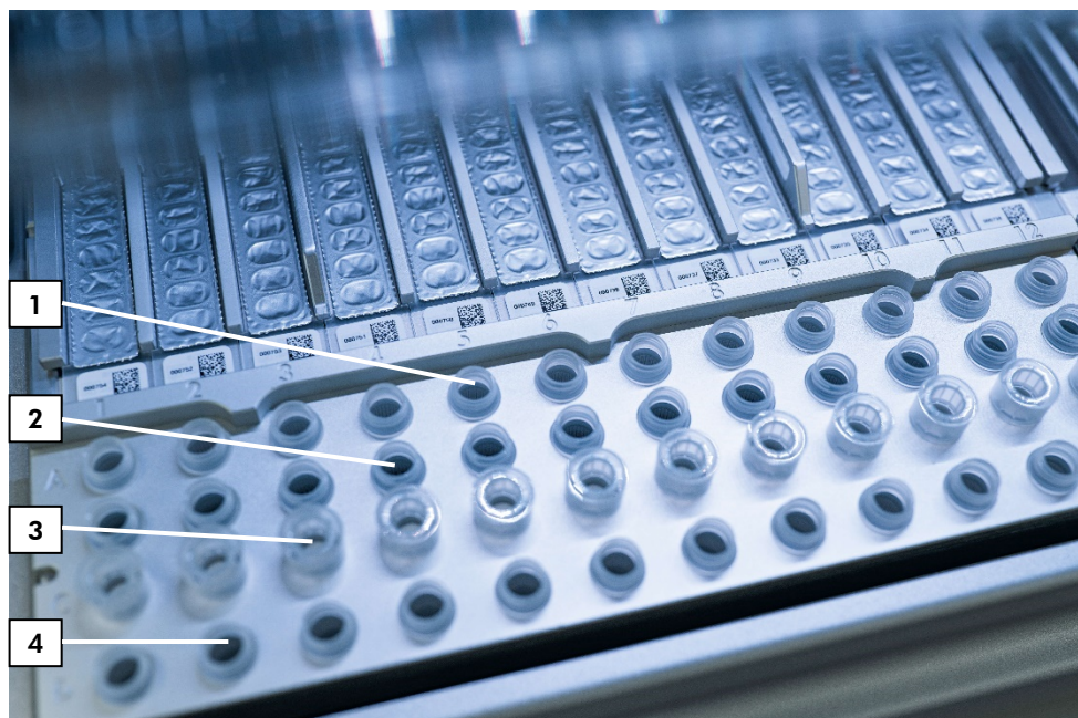
Figura 5. Mesa de trabalho de um instrumento EZ2 Connect MDx. (1) Tubos de amostra (ST) (2 ml) carregados na linha A. (2) Vazio ou opcional: Tubo (2 ml) contendo etanol a 80% para o passo de lavagem opcional, carregado na linha B. (3) Suportes de ponteiros descartáveis (DTH) contendo ponteiros com filtro descartáveis (DFT) carregados na linha C. (4) Tubos de eluição (ET) (1,5 ml) carregados na linha D.
