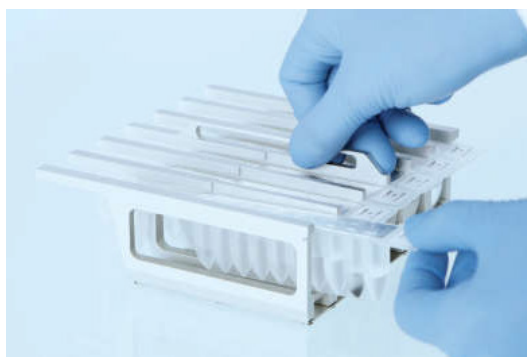
Figur 9. Laddning av stället för reagenskassett. Själva kassetstället är märkt med en pil för att ange i vilken riktning reagenskassetterna (RCV) måste laddas.
