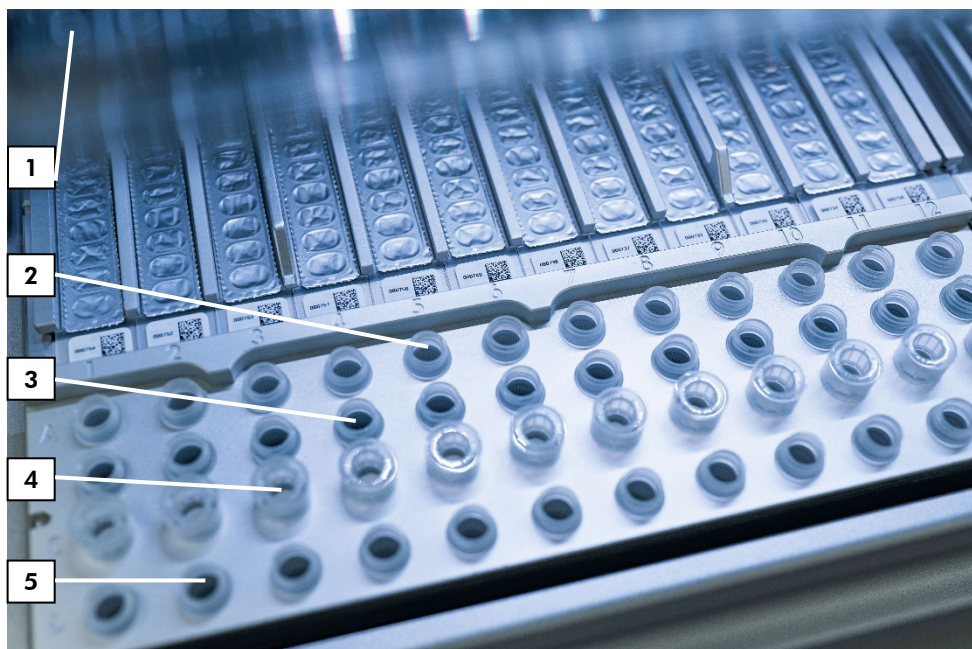
Figur 5. Arbetsbord för ett EZ2 Connect MDx-instrument. (1) Värmeblock med 2 ml rör (ST) laddade i reagenskassetten (reagent cartridge, RCV) för lysering. (2) Provrör (ST) (2 ml) laddade i rad A. (3) Rör (ET) (1,5 ml) som innehåller bärar-RNA (CARRIER) och intern kontroll (Internal Control, IC) (om sådan används) i elueringsbuffert (AVE), laddad i rad B. (4) Engångsspetsställare (DTH) som innehåller engångsfilterspetsar (DFT) laddade i rad C. (5) Elueringsrör (ET) (1,5 ml) laddade i rad D.
