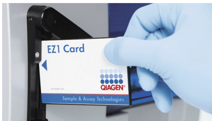
Figur 6. Enkel protokollinställning med användning av EZ1 DSP-kort. Sätta in ett EZ1 Card förprogrammerat med protokollet i EZ1-instrumentet.
