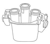
▼ チューブとスピンカラムが正し く設置されている状態
