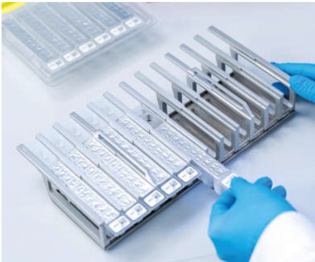
Afbeelding 3. Reagenscartridgerek. Het cartridgerek zelf heeft een pijl om de richting aan te geven waarin reagenscartridges (RCV) moeten worden geladen.
