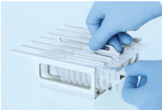
Afbeelding 9. Het reagenscartridgerek laden. Het cartridgerek zelf heeft een pijl om de richting aan te geven waarin reagenscartridges (RCV) moeten worden geladen.
