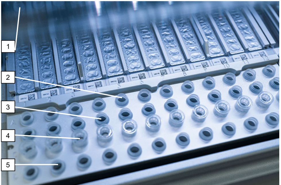
Afbeelding 5. Werktafel van een EZ2 Connect MDx-instrument. (1) Verwarmingsblok met buisjes van 2 ml (ST) geladen in de reagenscartridges (RCV's) voor lysis. (2) Monsterbuisjes (ST) (2 ml) geladen in rij A. (3) Buisje (ET) (1,5 ml) met drager-RNA (CARRIER) en interne controle (indien gebruikt) in elutiebuffer (AVE), geladen in rij B. (4) Wegwerptiphouders (DTH) met wegwerptiphouders (DFT) geladen in rij C. (5) Elutiebuisjes (ET) (1,5 ml) geladen in rij D.
