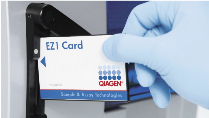
Afbeelding 6. Eenvoudige opstelling van het protocol met behulp van EZ1 DSP Cards. Invoegen van een EZ1 Card, vooraf geprogrammeerd met het protocol, in het EZ1-instrument.
