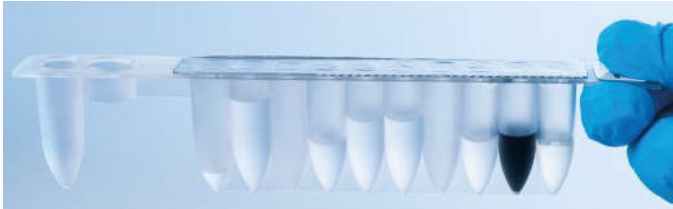
Afbeelding 8. Reagenscartridge (RCV) Een afgedichte, vooraf gevulde RCV van de EZ1 DSP Virus Kit.
