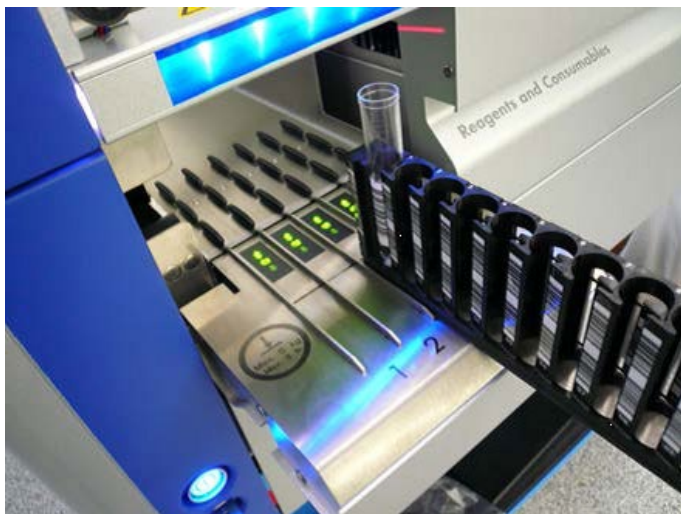
Glisarea unui suport de eprubete în fanta corespunzătoare.
