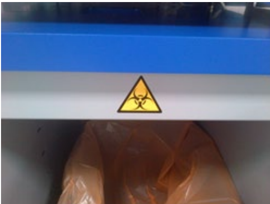
* Poziția etichetei de avertizare a pericolului biologic, pe panoul dulapului (SP).
