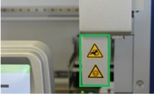
† Poziția etichetei de avertizare a pericolului de strivire și a etichetei de avertizare cu privire la lumina UV (SP/AS).
