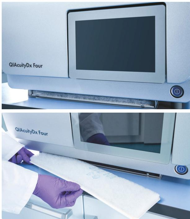
4. Reemplace con un filtro nuevo y empuje el compartimiento basculante hacia arriba hasta la parte superior y haga clic para cerrar.
