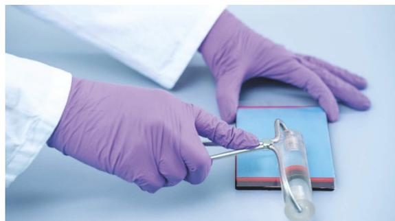
7. El marco de la placa ofrece la opción de marcar la placa con un rotulador. Utilice únicamente el carril situado entre el borde de la placa y las letras impresas (junto a la columna 1), así como la parte reflejada (desde la columna 12 hasta el borde de la placa). No se recomienda marcar el sello de la placa por encima de los pocillos, ya que podría provocar un llenado inadecuado de los pocillos.
