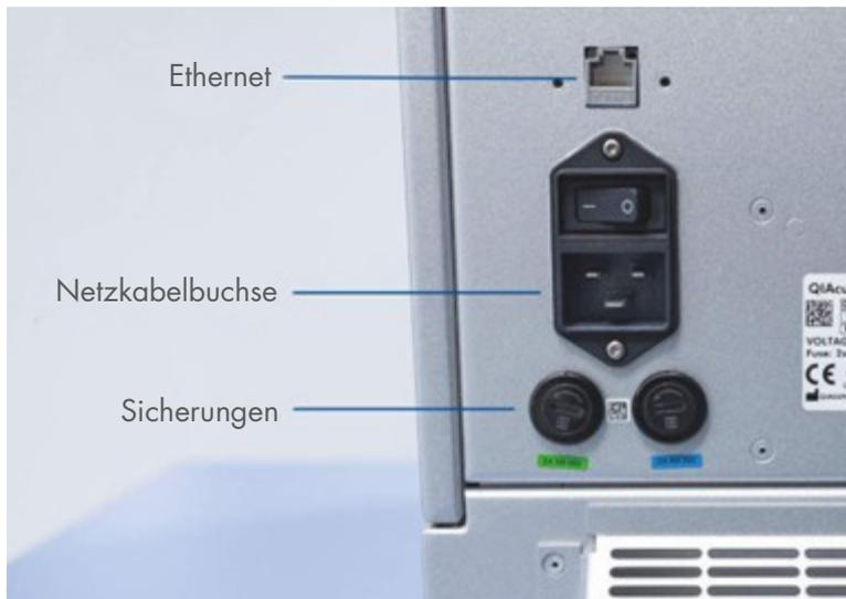
Abbildung 6. Rückansicht des QIAcuityDx.
