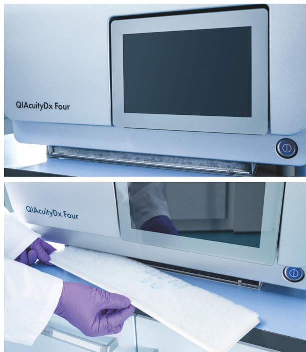
4. Legen Sie einen neuen Filter ein, drücken Sie das Klappfach nach oben und klicken Sie zum Schließen.
