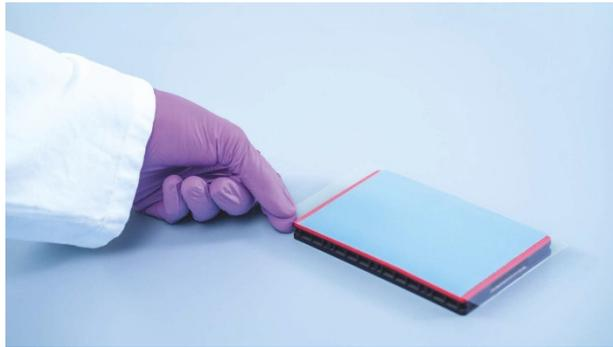
5. Anschließend wird die obere Schutzfolie an der linken unteren Ecke abgezogen. Es wird empfohlen, die Gummifolie an der Plattenecke mit einem Finger festzuhalten, während die obere transparente Folie abgezogen wird. Wenn die obere Folie auf andere Weise abgezogen würde, könnte sich die Plattenversiegelung lösen.
