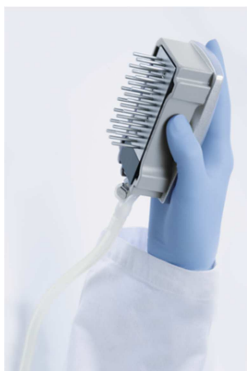
Figura 4. Ilustração da ferramenta a vácuo erguida excedendo um ângulo de 90° na vertical.
