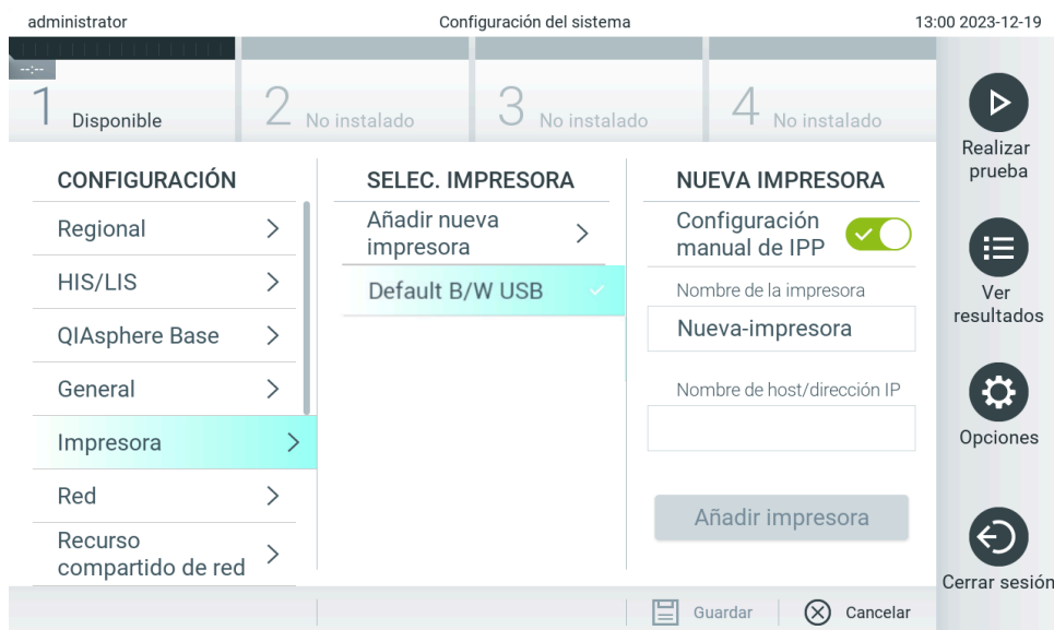
Figura 105. Instalación de la impresora con configuración de IPP manual.
