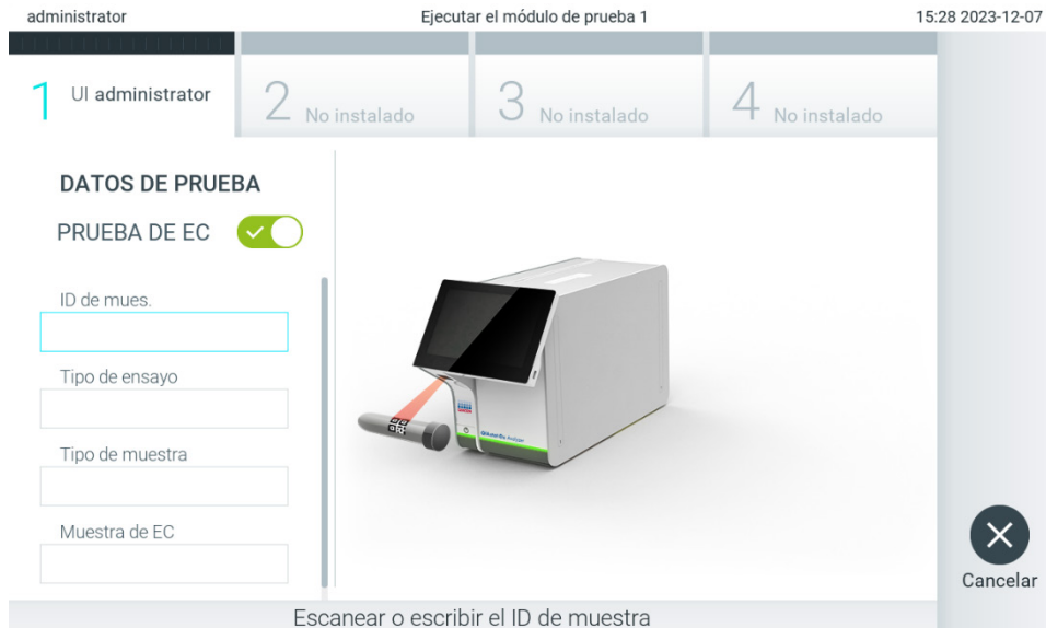
Figura 92. Activación del botón de alternancia EC Test (Prueba de EC) para habilitar una prueba de EC.
