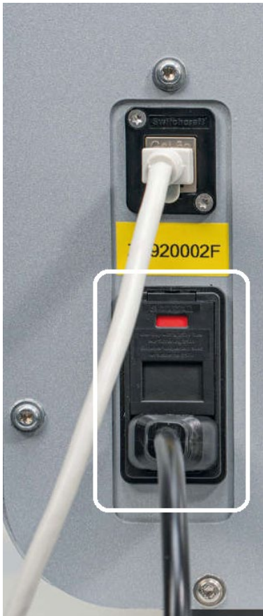
Bild 7. Placering av elanslutningen (markeras med en vit ram).
