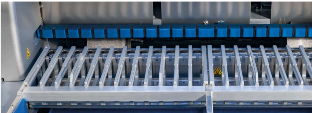
Bild 12. Avtagbart kassetställ inuti instrumentet.
