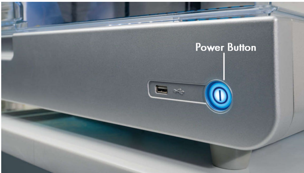
Bild 5. Placering av strömknappen.
