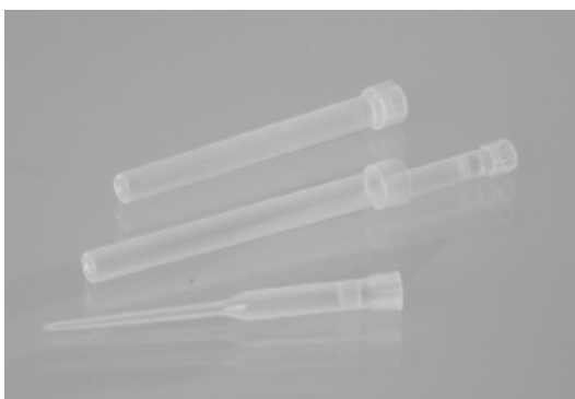
Bild 16. Spetsållare och filterspetsar.
