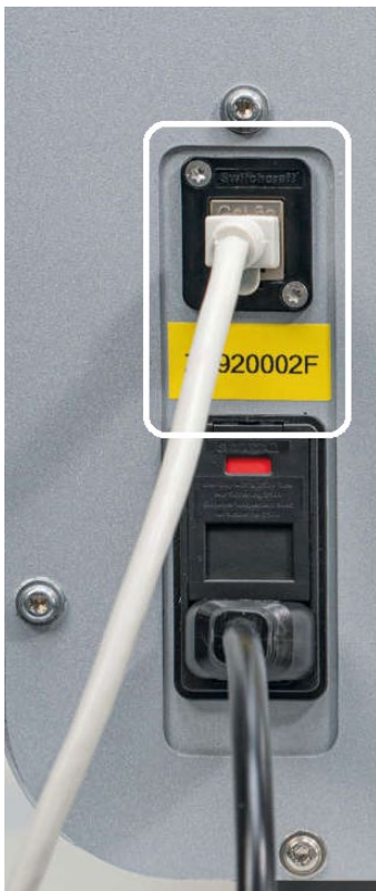
Bild 6. Placering av RJ-45-porten (markeras med en vit ram).
