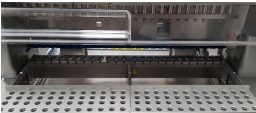
Bild 15. Spetsställ inuti instrumentet.
