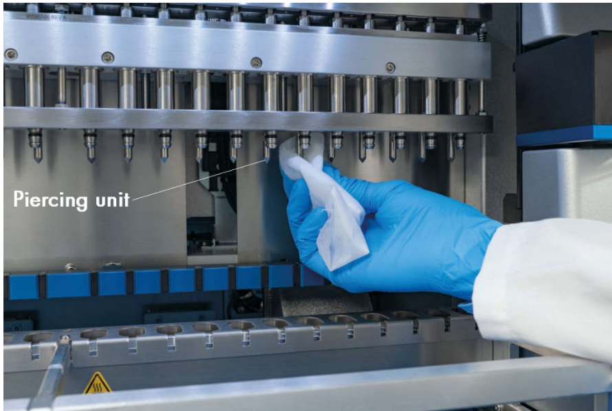
Bild 174. Rengöring av håltagningsenheten på EZ2.
