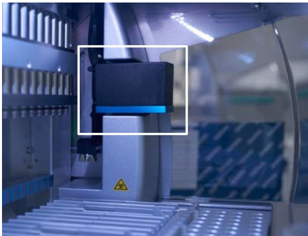
Bild 20. Kameraenheten (markeras med en vit ram).
