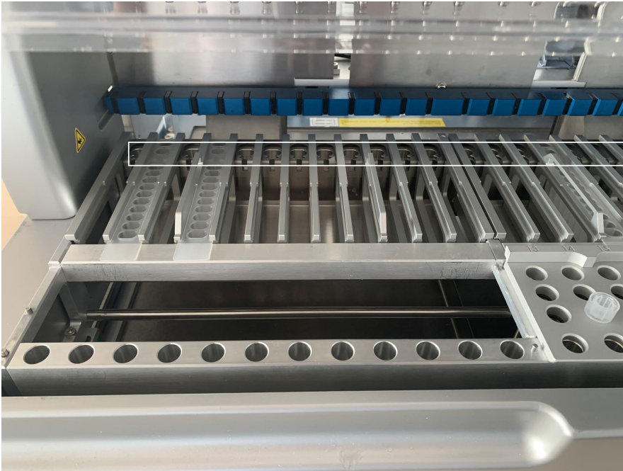
Bild 17. Uppvärmningsbara positioner i kassetstället (markerade med en vit ram).
