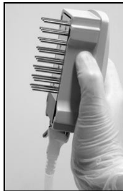
Figura 6. Illustrazione dello strumento di vuoto sollevato oltre i 90° in verticale.
