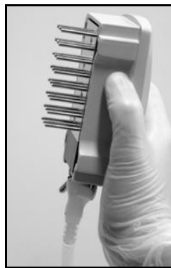
Figura 10. Illustrazione dello strumento di vuoto sollevato oltre i 90° in verticale.
