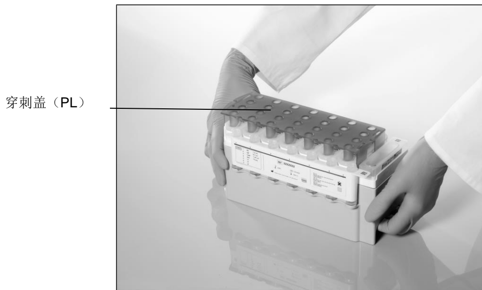
图3.使用试剂盒（RC）实施简易工作台设置。
