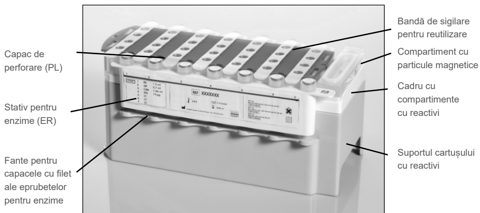
Figura 2. Cartuș cu reactivi (RC) QIASymphony. Cartușul cu reactivi (RC) conține toți reactivii necesari pentru execuția protocolului.
