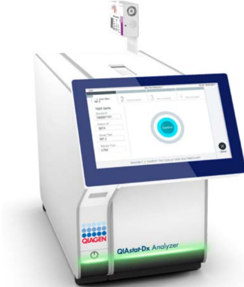
Şekil 15. QIAstat-Dx Gastrointestinal Panel Cartridge'i QIAstat-Dx Analyzer 1.0 cihazına yerleştirme.
