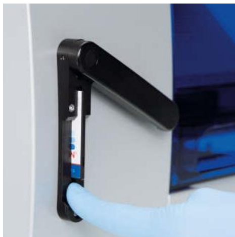
Figur 7. Kort satt helt inn i EZ1 Card-sporet.
