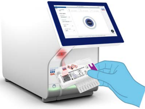
그림 13. QIAstat-Dx Gastrointestinal Panel Cartridge 바코드 스캔.
