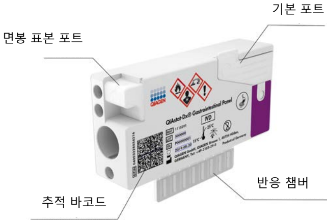
그림 1. QIAstat-Dx Gastrointestinal Panel Cartridge 및 그 기능에 대한 개요.
