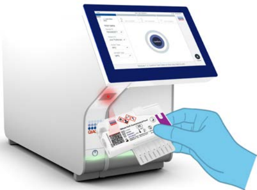
Joonis 13. Kasseti QIAstat-Dx Gastrointestinal Panel Cartridge vöökoodi skannimine
