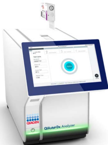
Joonis 15. Kasseti QIAstat-Dx Gastrointestinal Panel Cartridge sisestamine analüsaatorisse QIAstat-Dx Analyzer 1.0
