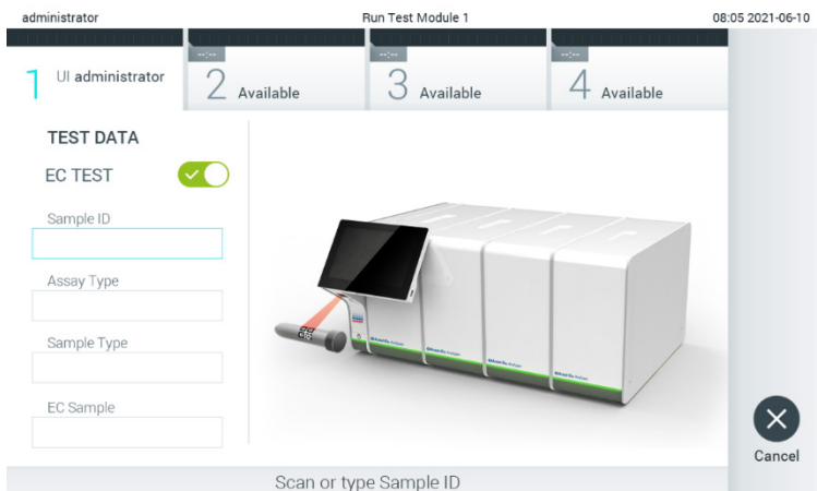
Εικόνα 89. Ενεργοποίηση κουμπιού επιλογής EC Test (Δοκιμασία EC) για ενεργοποίηση δοκιμασίας εξωτερικού ελέγχου.
