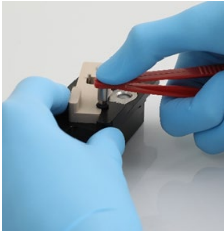
Herunterdrücken des Stifts mit dem hinteren Ende der Pinzette.
