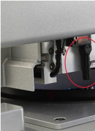
Schwarzer Strahlenkollimator (siehe roter Kreis) des Ultraschallsensors.
