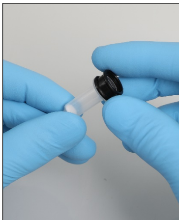
Befestigen eines Spin-Säulen-Adapterrings.
