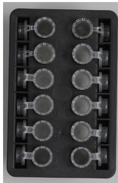
Deckel der Probenröhrchen müssen fest in die Schlitzte an den Seiten des Schüttlergestells gesetzt werden
