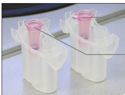
Vergleich korrekt und inkorrekt entfernter Säulendeckel.
