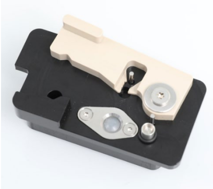
O-Ring-Tool mit vorbereitetem neuem O-Ring.
