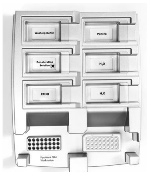
Bild 2. Placering av PCR-platta (eller remsor) och PyroMark Q24-platta på vakuumbrytaren.
