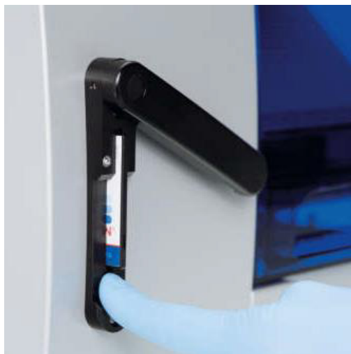
Figura 7. EZ1 Card introdus complet în slotul pentru EZ1 Card.
