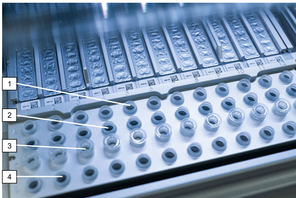
Figura 5. Masa de lucru a unui instrument EZ2 Connect MDx. (1) Eprubete pentru probe (ST) (2 ml) încărcate în rândul A. (2) Goale sau opțional: Eprubetă (2 ml) care conține etanol 80% pentru etapa de spălare opțională, încărcată pe rândul B. (3) Stative pentru vârfuri de unică folosință (disposable tip holders, DTH), care conțin vârfuri cu filtru de unică folosință (disposable filter-tips, DFT) încărcate pe rândul C. (4) Eprubete pentru eluție (ET) (1,5 ml) încărcate în rândul D.
