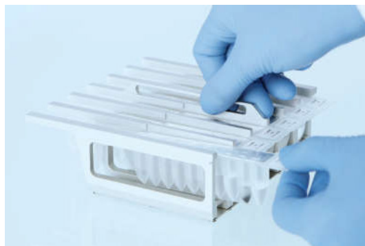
Figura 9. Încărcarea stativului pentru cartușe cu reactivi. Stativul pentru cartușe este etichetat cu o săgeată pentru a indica direcția în care trebuie încărcate cartușele cu reactivi (RCB).
