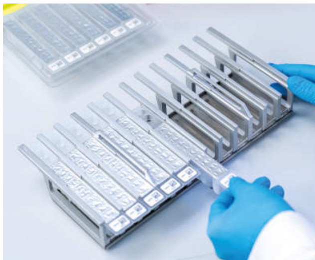
Figura 3. Stativul pentru cartușe cu reactivi. Stativul pentru cartușe este etichetat cu o săgeată pentru a indica direcția în care trebuie încărcate cartușele cu reactivi (RCB).
