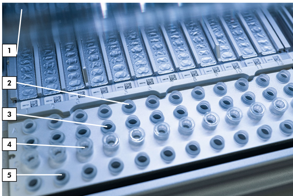
Figur 5. Arbejdsbordet på et EZ2 Connect MDx-instrument. (1) Varmeblok med 2 ml rør (ST) isat i reagenspatronerne (RCV) med henblik på lysis. (2) Prøverør (ST) (2 ml) isat i række A. (3) Rør (ET) (1,5 ml) med carrier-RNA (CARRIER) og intern kontrol (Internal Control, IC) (hvis den anvendes) i elueringsbuffer (AVE) isat i række B. (4) Spidsholdere til engangsbrug (DTH) med engangsfilterspidser (DFT) isat i række C. (5) Elueringsrør (ET) (1,5 ml) isat i række D.
