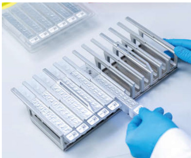
Figur 3. Holder til reagenspatron. Selve patronholderen er markeret med en pil for at vise den retning, reagenspatronerne (RCV) skal isættes i.
