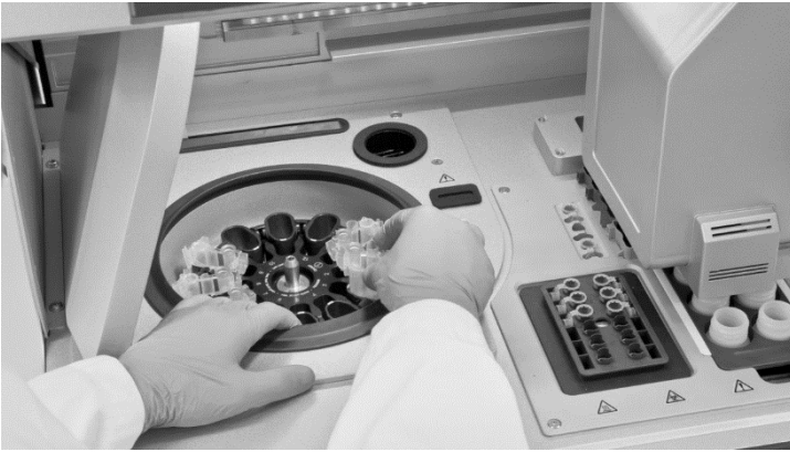
圖 21：裝載 QIAcube Connect MDx 的離心機。將組裝好的轉子轉接器裝載至離心筒內。
