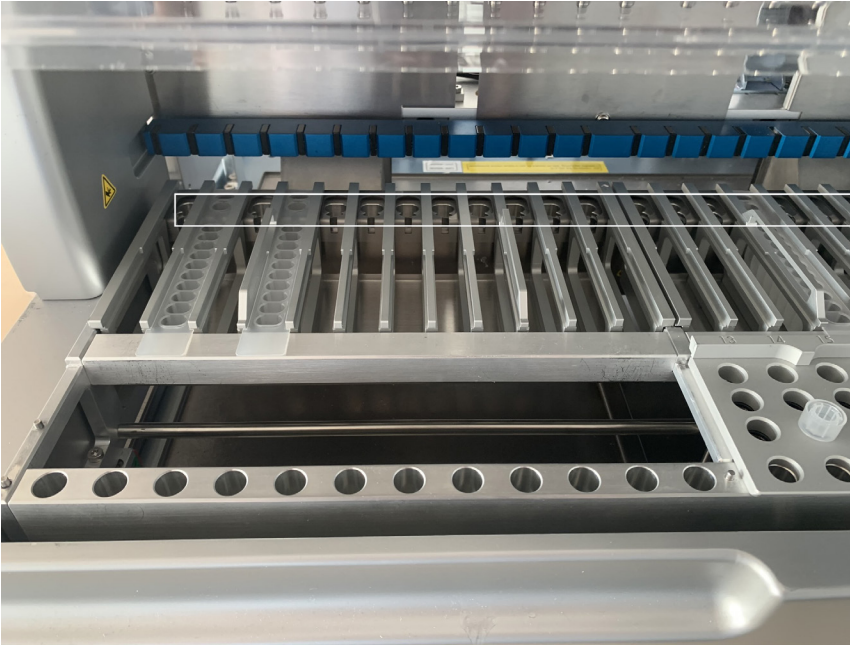
그림 16. 카트리지 랙에서 가열할 수 있는 위치(흰색 테두리로 표시).
