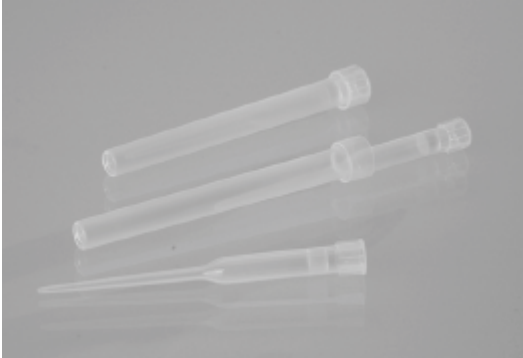
Εικόνα 15. Υποδοχές ρυγχών και ρύγχη πιπέτας με φίλτρο.
