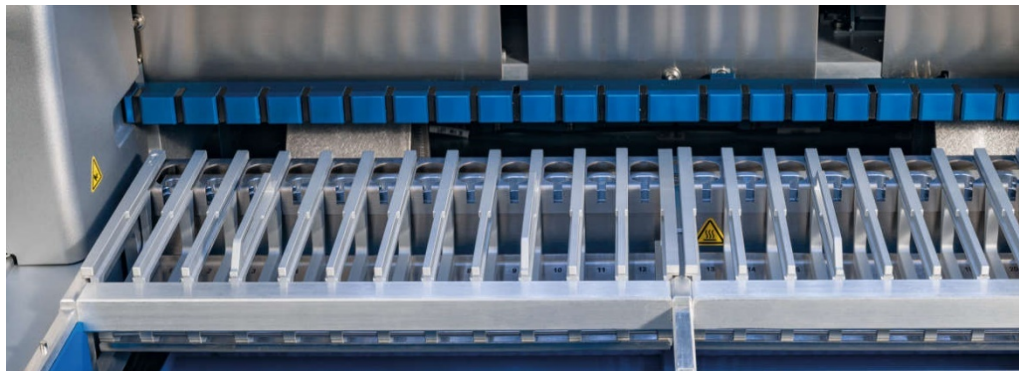
Εικόνα 11. Αφαιρούμενη βάση στήριξης φυσιγγων μέσα στο όργανο.
