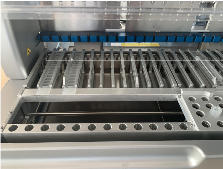
Εικόνα 16. Οι θερμαινόμενες θέσεις στη βάση στήριξης φυσιγγων (επισημαίνονται με λευκό πλαίσιο).
