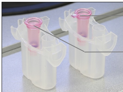
Comparaison entre des couvercles de colonnes qui ont été bien ou mal retirés
