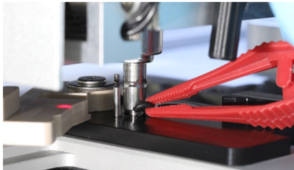
Ouvrir le levier gris et retirer le joint torique à l'aide de la pincette.
