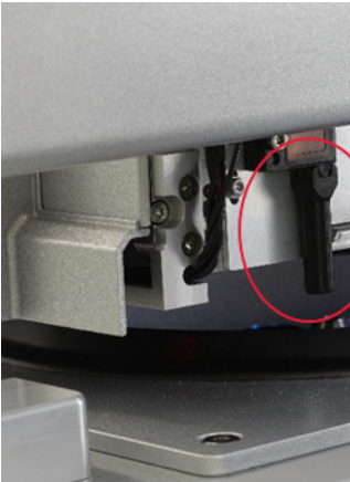
Collimateur de faisceau noir (dans le cercle rouge) du capteur ultrasonique
