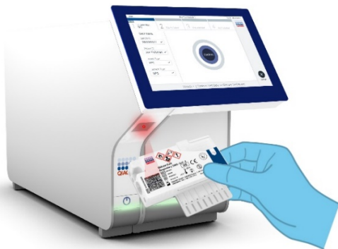
Figura 45. Scanarea codului de bare al QIAstat-Dx Respiratory SARS-CoV-2 Panel Cartridge.
