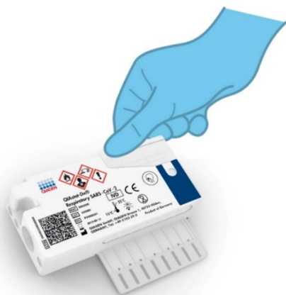
Figura 42. Închiderea capacului probei aferent orificiului principal.
