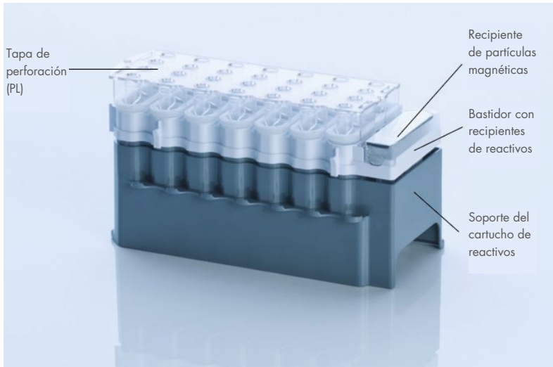
Figura 2. Cartucho de reactivos del instrumento QIASymphony. El cartucho de reactivos contiene todos los reactivos necesarios para la ejecución del protocolo.
