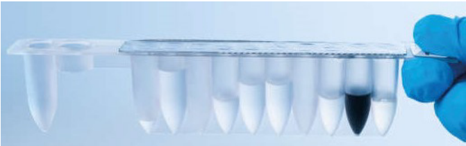
그림 2. 시약 카트리지(RCV), EZ1 DSP Virus Kit 의 밀봉된 사전 충전 시약 카트리지(RCV).
