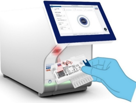
Şekil 12. QIAstat-Dx Respiratory SARS-CoV-2 Panel Cartridge barkodunu tarama.
