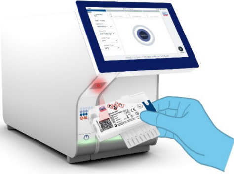
Şekil 45. QIAstat-Dx Respiratory SARS-CoV-2 Panel Cartridge barkodunu tarama.
