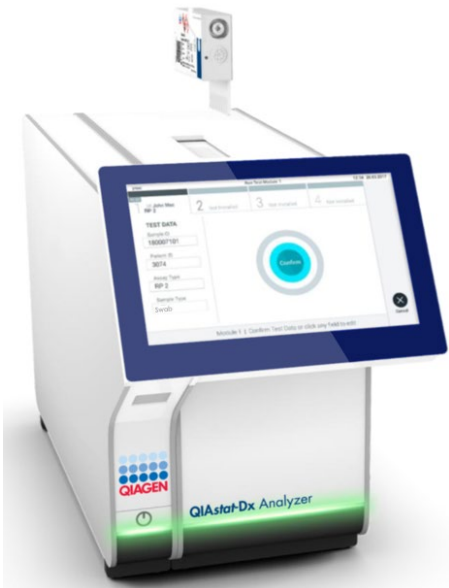
Figur 15. Indsætning af QIAstat-Dx Respiratory SARS-CoV-2 Panel Cartridge i QIAstat-Dx Analyzer 1.0 eller QIAstat-Dx Analyzer 2.0.
