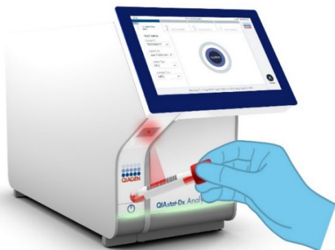
Figur 11. Scanning af prøve-ID-stregkode.
