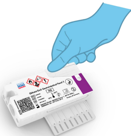
Figur 8. Lukning af låget til hovedporten.
