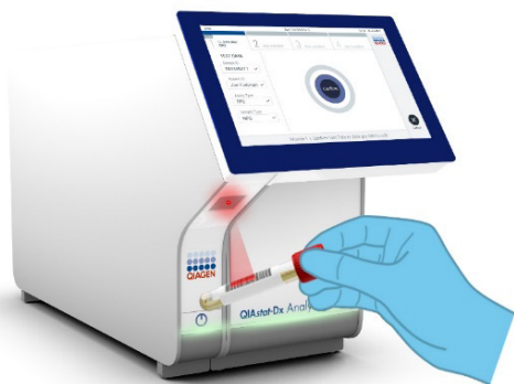
Figur 10. Scanning af prøve-ID-stregkode.
