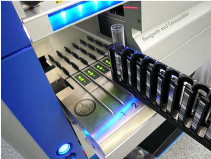
Putkikuljettimen liu'uttaminen aukkoonsa
