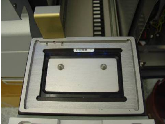
Eluate (Eluaatti) -lokeron aukkoon 1 asetettu siirtokehikko.
