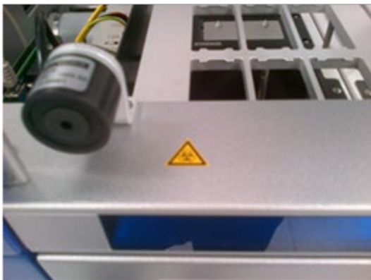
† Biologinen vaara -merkinnän paikka työalustassa, suojuksen magneettilukon lähellä (AS).
