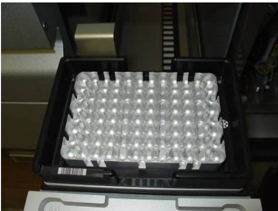
Eluate (Eluaatti) -lokeron aukon 1 siirtokehikkoon asetettu sovitin.
