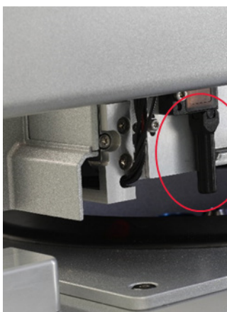
Ultraljudsensorns svarta strålkollimator (se röd cirkel).
