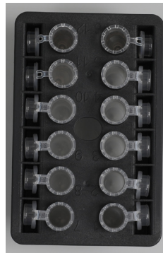
Locken på provrören måste placeras säkert i skåror på skakapparatställets kant
