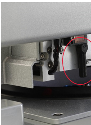
Ultralydssensorens sorte strålekollimator (se rød cirkel).
