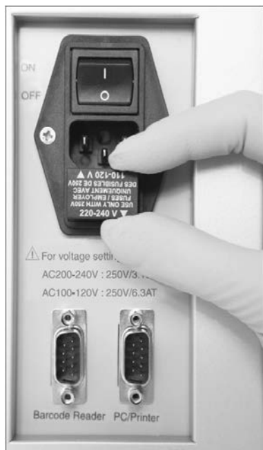
Výběr správné pojistky pro zdroj napětí 200–240 V
