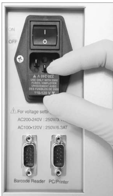
Valg af den rigtige sikring til 100-120 V-strømforsyning.
