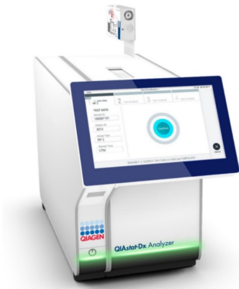
Obrázok 48. Vloženie kazety QIAstat-Dx Respiratory SARS-CoV-2 Panel Cartridge do analyzátoru QIAstat-Dx Analyzer 1.0 alebo QIAstat-Dx Analyzer 2.0.
