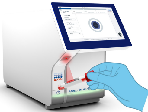
24. ábra: A mintaazonosító vonalkód beszkenelése.
