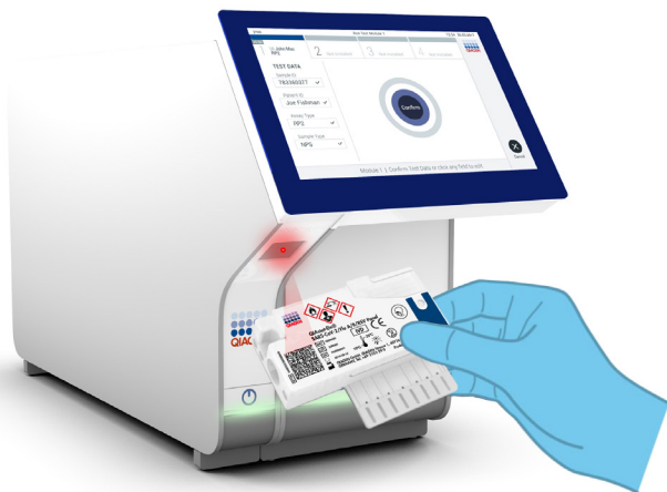
12. ábra. A QIAstat-Dx SARS-CoV-2/Flu A/B/RSV Panel Cartridge vonalkódjának beolvasása.
