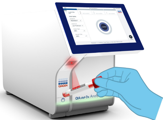
11. ábra: A mintaazonosító vonalkód beszkennelése.
