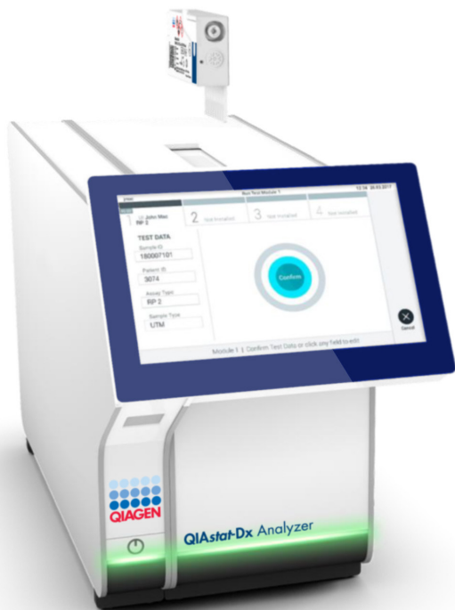
15. ábra: A QIAstat-Dx SARS-CoV-2/Flu A/B/RSV Panel Cartridge kazetta behelyezése a QIAstat-Dx Analyzer 1.0 vagy a QIAstat-Dx Analyzer 2.0 készülékbe.
