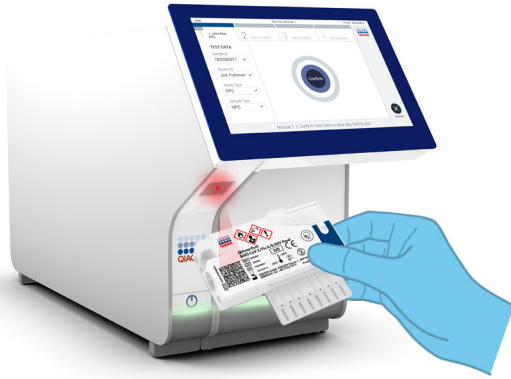
25. ábra: A QIAstat-Dx SARS-CoV-2/Flu A/B/RSV Panel Cartridge vonalkódjának beolvasása.
