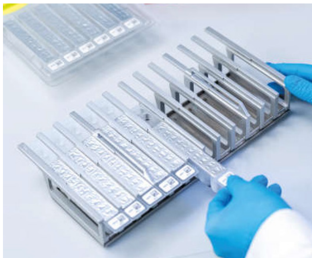
3 ábra. Reagenskazetta-tartó. A kazettatartó állványon látható nyíl jelzi, hogy milyen irányban kell betölteni a reagenskazettákat (RCB).
