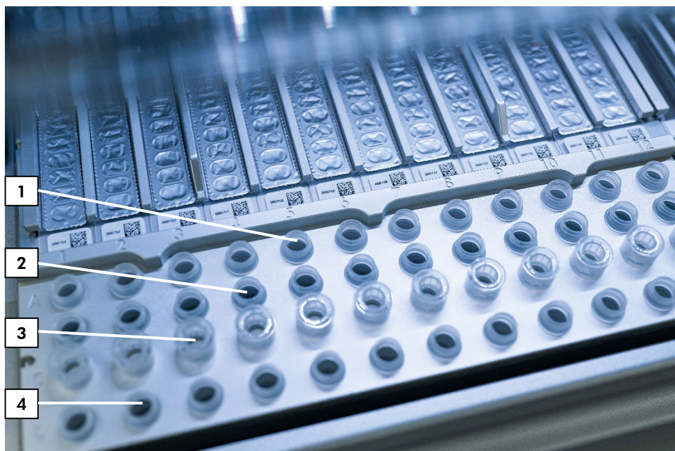
5. ábra. Az EZ2 Connect MDx készülék munkasztala. (1) Az A sorba betöltött mintacsövek (ST) (2 ml). (2) Üres vagy opcionális: 80%-os etanolt tartalmazó cső (2 ml) az opcionális mosási lépéshez, a B sorba töltve. (3) A C sorba töltött egyszer használatos hegytartók (DTH), amelyek egyszer használatos, szűrővel rendelkező hegyeket (DFT) tartalmaznak. (4) A D sorba töltött elúciós csövek (ET) (1,5 ml).
