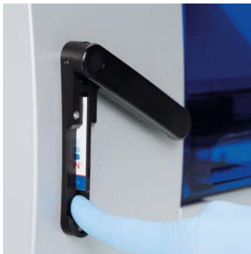
7. ábra. Az EZ1 Card kártyanyílásába teljesen behelyezett EZ1 Card.
