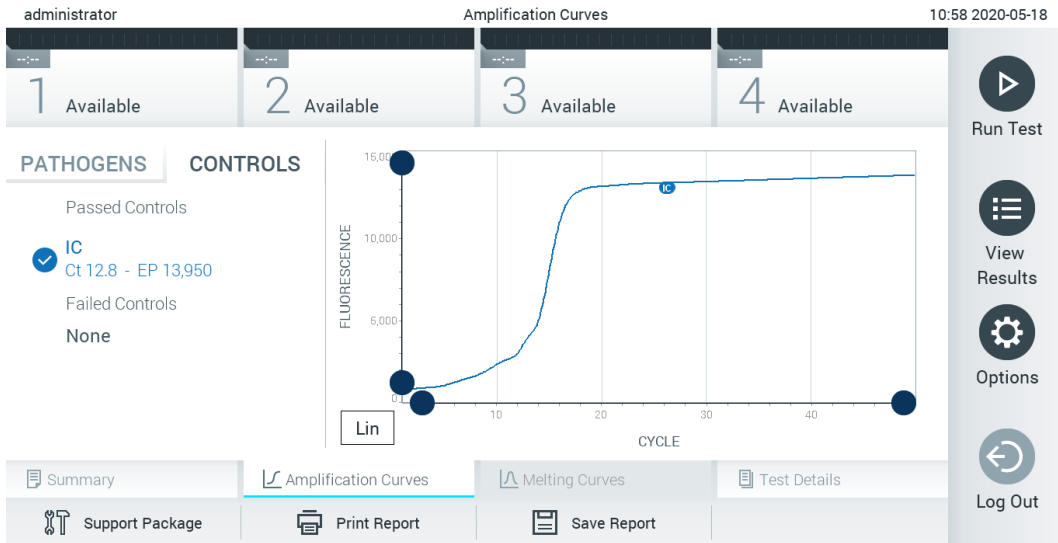
图 35. 显示内部对照品的 Amplification Curves (扩增曲线) 屏幕 (CONTROLS (对照品) 选项卡)。
