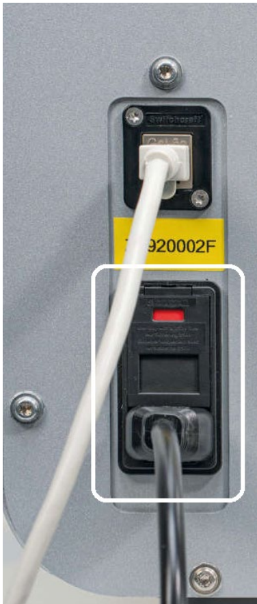
Figura 7. Localização da tomada do cabo de alimentação (realçada por uma moldura branca).
