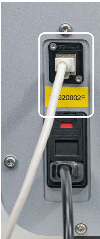
Figura 6. Localização da porta RJ-45 (realçada por uma moldura branca).
