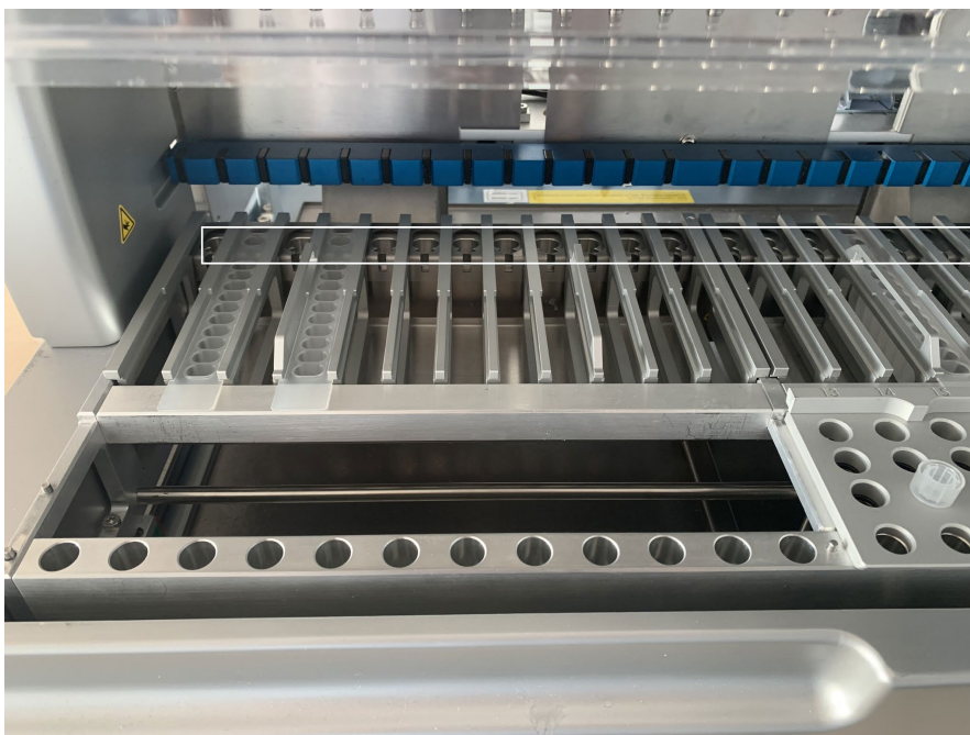
Figura 17. Posições que podem ser aquecidas no suporte de cartuchos (realçadas por uma moldura branca).
