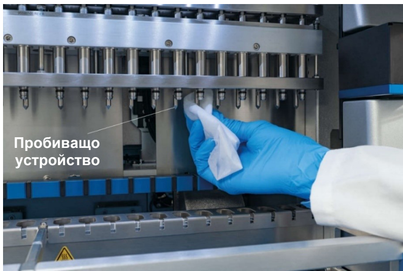
Фигура 147. Почистване на пробиващото устройство на E22.
