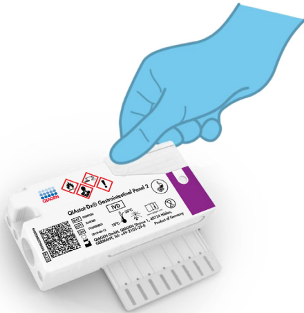
Kuva 8. Pääaukon kannen sulkeminen.
