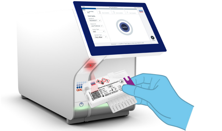
Kuva 11. QIAstat-Dx Gastrointestinal Panel 2 Cartridge -kasetin viivakoodin skannaaminen.
